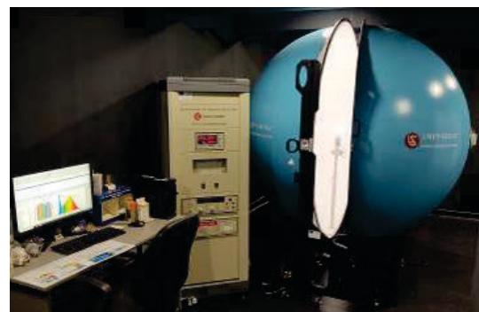
Фиг. 2. Спектрорадиометър LMS-9000B с интегрираща сфера с диаметър 2 m
