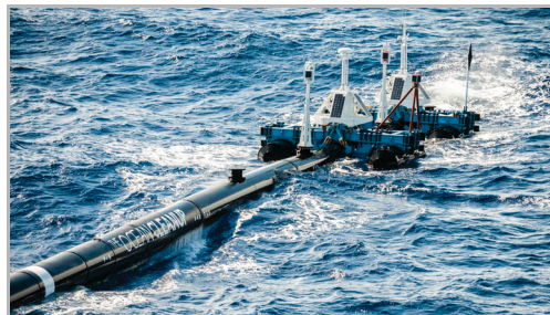
Фиг. 1. Плаваща бариерна система (По данни на проект Ocean Cleanup)
