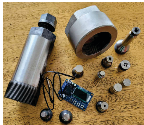
Фиг. 1. Дебелостенната камера и част от съпътстващите я компоненти
