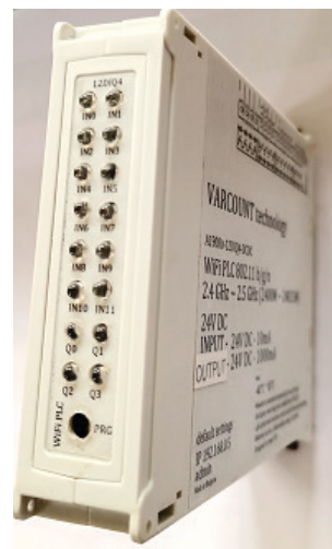
Фиг.4 Контролер за комуникация с компютър за обработка на данни от софтуер за стерео виждане
