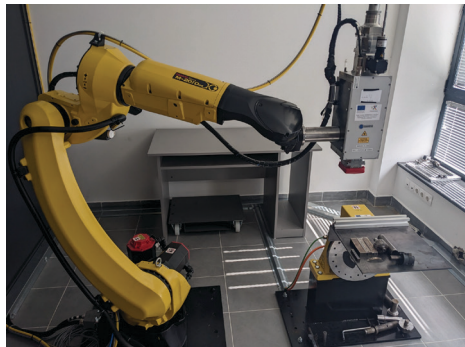
Фиг. 4. Позиционираща система за повърхностна обработка на сложни 3Д повърхнини
