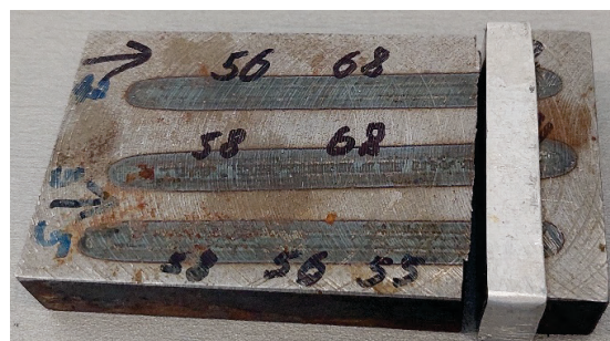
Фиг. 7. Обработен образец от стомана 45 с дължина 70 mm, размер на лазерното петно (5,5 \times 8)\text{mm} и измерена твърдост
