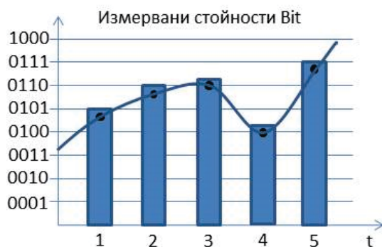
Фиг. 6. Четири-разрядно квантоване на аналогов сигнал от пожарен детектор
