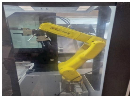
Фиг. 1. Работно пространство на CNC струг HARRIS с роботизирана станция за хранване BOXI Raptor Auto Loader
