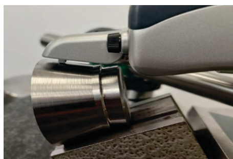
Фиг. 4. Установка за измерване на грапавостта на образците
