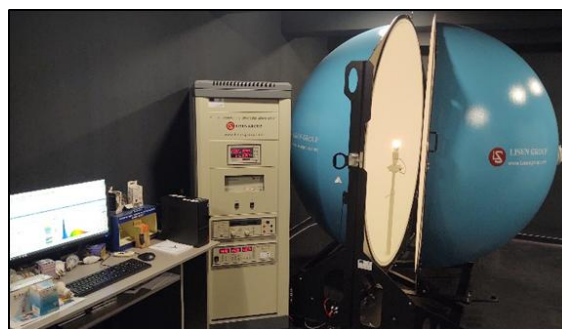
Фиг. 1. Външен вид на спектрорадиометър LMS-9000B, използван за изследванията
