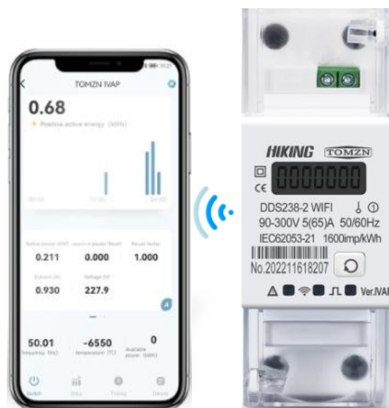
Фиг. 6. Електромер и приложение за дистанционен контрол чрез смартфон
