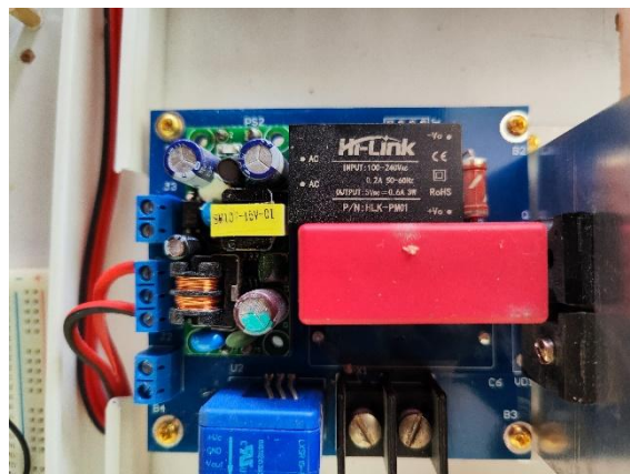
Фиг. 3. Транзисторен модул за свързване към всяко звено на многозвения индуктор.
