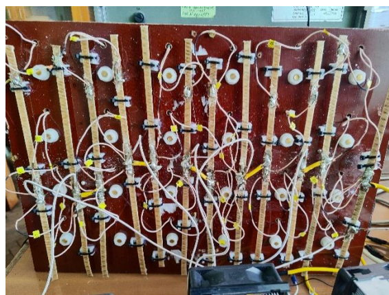
Фиг. 2. Свързване по стълбове на многозвения индуктор за ИК.
