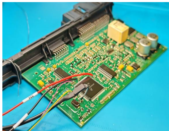
Фиг.4 Четене с програматор от интегралната схема на криптиран процесор от имобилайзер на BMW CAS4 използван в F шаситата. Въпросният имобилайзер използва ключ с Hitag Pro технология (успешен експеримент извършен от авторите).
