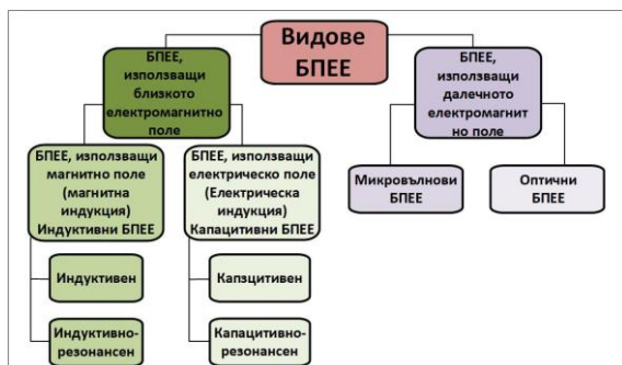
Фиг. 1. Видове БПЕЕ според вида на електромагнитното поле, което използват за пренос на енергия.
