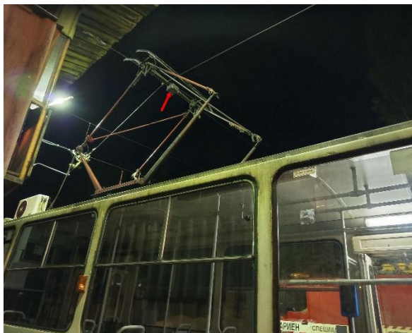
Фиг. 3. Монтирана измервателна система на токоприемника в работно положение
