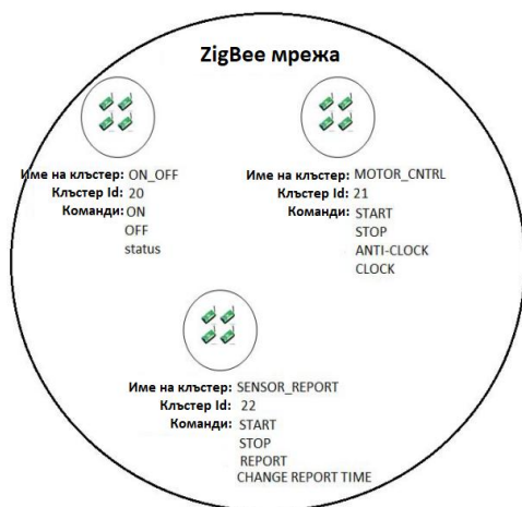
Фиг. 7. Клъстерно базирана Zigbee мрежа
