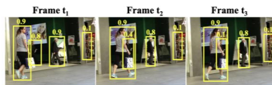
Фиг. 2. Последователност от три кадъра ( t_1 , t_2 , t_3 ), при която ByteTrack използва както високодостоверни, така и нискодостоверни детекции за непрекъснато проследяване на обекта [8].
