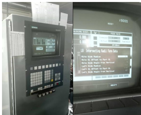
Фиг. 7. Пулт за управление и програмиране на специализирана шлифовъчна машина NORMAC FTX2
