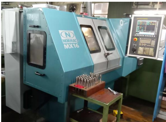
Фиг. 3. Общ вид на специализирана шлифовъчна машина NORMAC MX16
