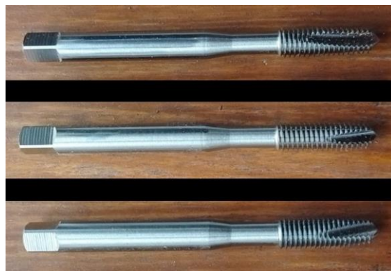
Фиг. 10. Изработени метчици М8 с различна дължина на формообразуващата част
