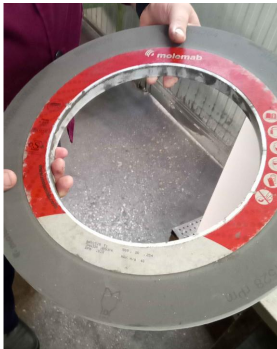
Фиг. 5. Абразивен диск за шлифование на резбови профил при NORMAC MX16
