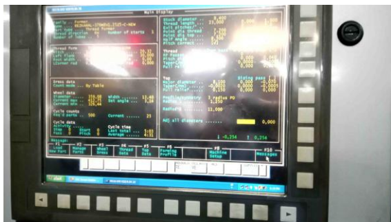
Фиг. 9. Пулт за управление и програмиране на специализирана шлифовъчна машина MX16
