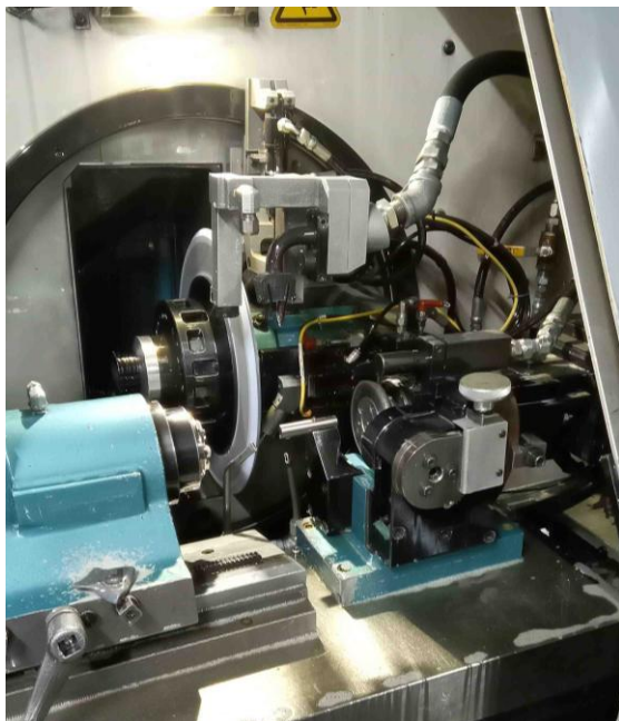
Фиг. 8. Работен вид и зона за обслужване на специализирана шлифовъчна машина NORMAC MX16
