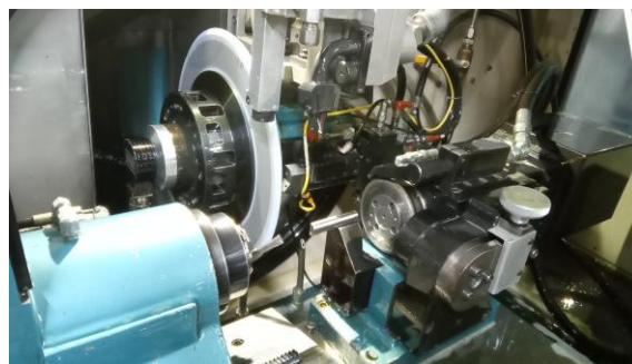
Фиг. 6. Работно положение на диамантена изравнителна ролка
