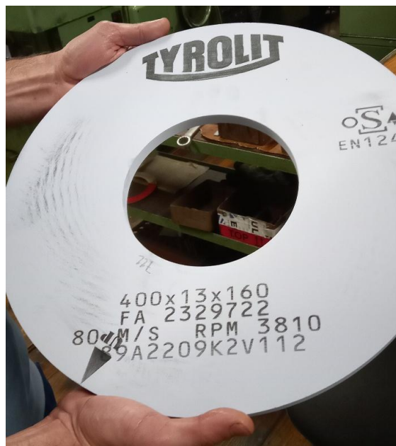
Фиг. 4. Абразивен диск за шлифование на резбови профил
