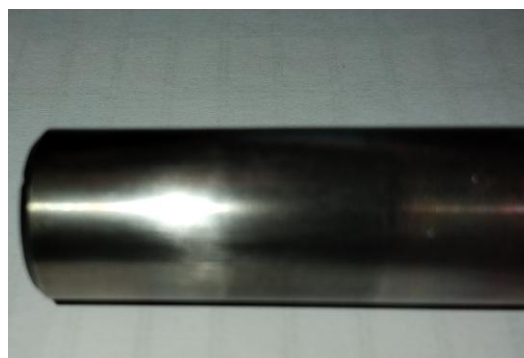
Фиг. 6. Пробно тяло след извършена лазерна обработка
